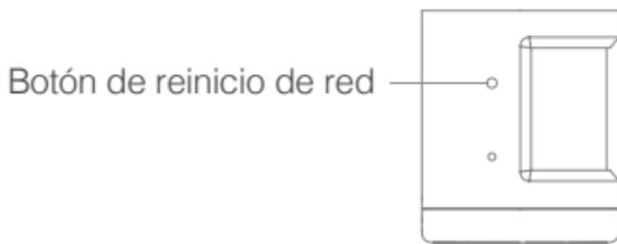
Mantenga presionado el botón de reinicio durante 5 segundos, hasta que la luz indicadora de la red comience a parpadear. Siga las instrucciones de la aplicación para agregar el dispositivo.
