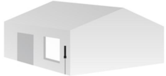
**NOTA:** El dispositivo Reply requiere una separación vertical de 4.5 [m] como mínimo entre la unidad base y la antena de señal. Normalmente, al aumentar la distancia de separación (hasta 12 [m]), mejora la eficacia de Reply y si se reduce se limita su rendimiento.
